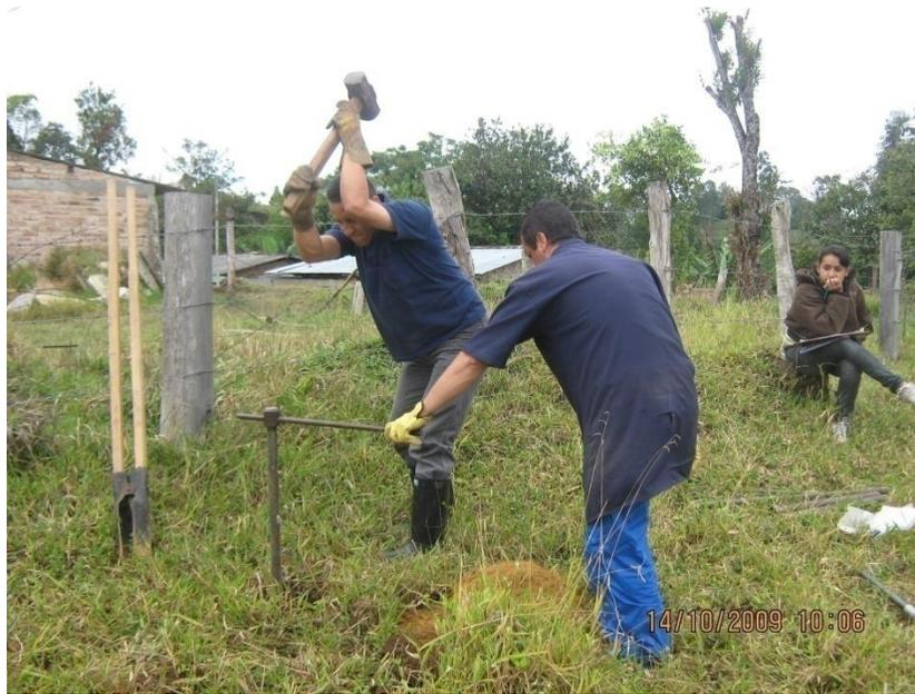
Figura N°8 Extracción de muestra inalterada en sitio donde se ubicará el tanque N°2.
