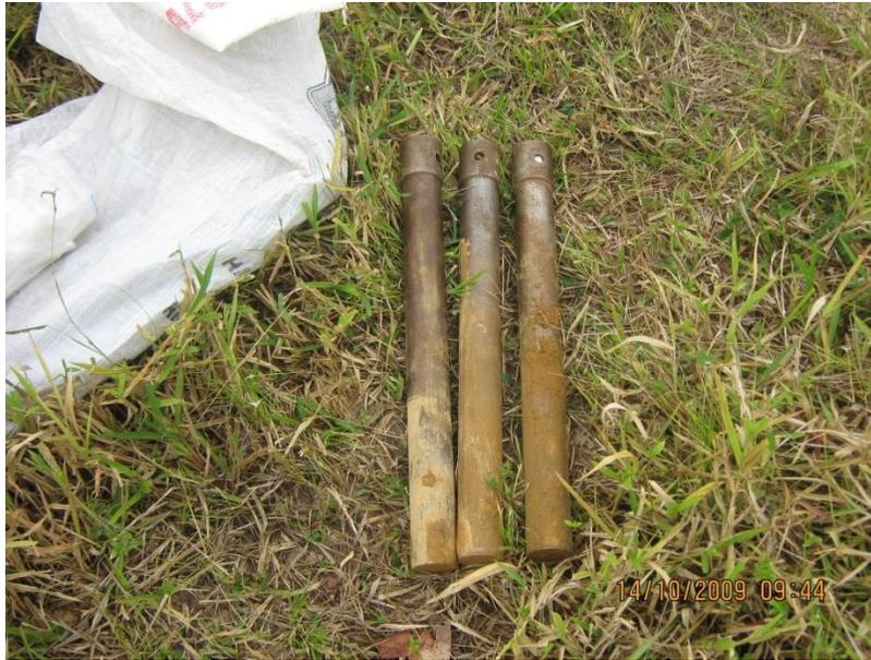
Figura N°6 Tubos shelby extraídos en el lugar donde se construirá el tanque N°1
