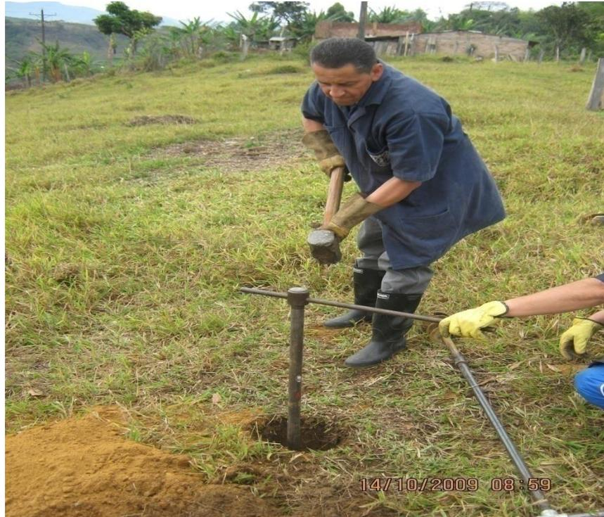
Figura N° 4 Toma de muestra inalterada por medio del tubo shelby.
