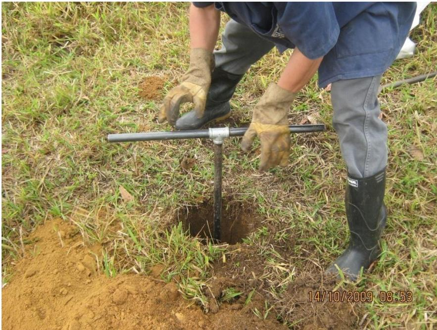
Figura N°3 Maniobras con el elemento de ataque helicoidal.
