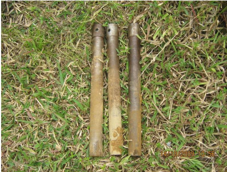
Figura N°10 Tubos Shelby extraídos en el sitio del tanque N°2.
