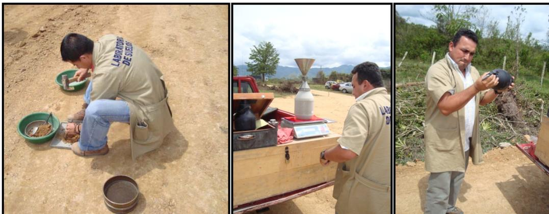
Fotos 12. Ensayo de densidades con cono de arena y humedades con speedy.
