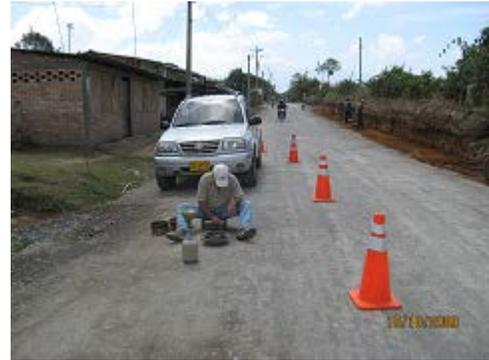
**FOTO Nº 100** Ensayos de densidades capa sub-base
