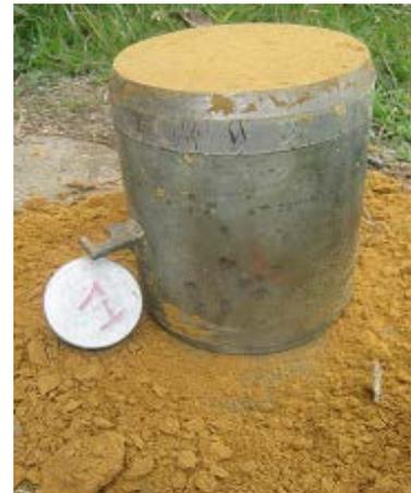
**FOTO N° 38** Muestra para CBR N° 1 ubicado en K5+655(lado derecho)
