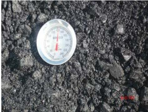
**FOTO N° 17** Verificación temperatura adecuada de la mezcla
