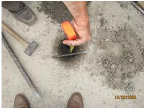
**FOTO N° 106** Ensayos verificando el espesor
