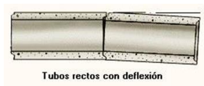
Figura 23. Deflexiones en tubos de concreto.
