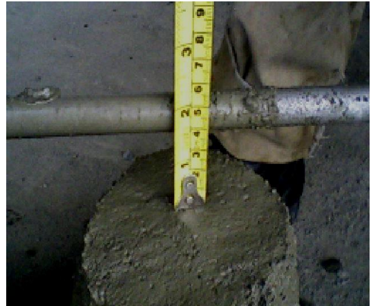
Figura 151. Medida del asentamiento
