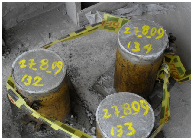
Figura 152. Elaboración de cilindros
