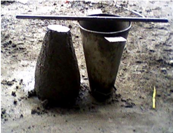
Figura 150. Prueba de slump realizada en la obra
