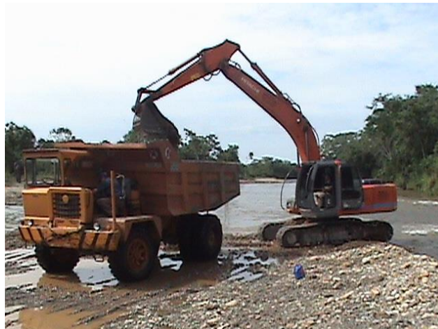
Fotografía No.3 Explotación de material crudo de rio, Fuente Santa Marta. Rio Guineo
