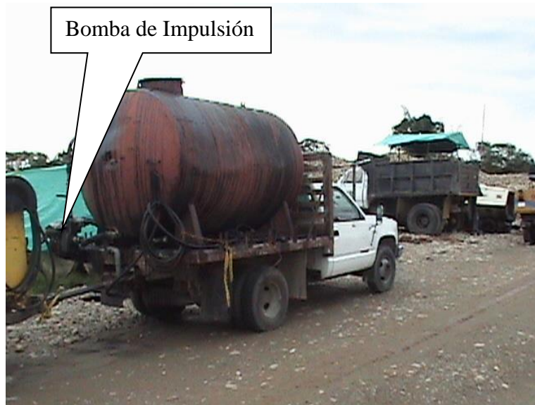
Fotografía No.42 Carro tanque irrigador Provisto de bomba de impulsión por cauda
