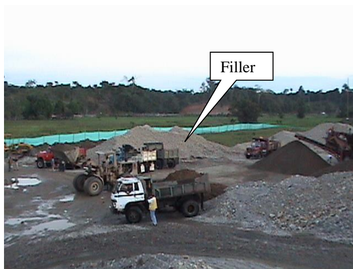
Fotografía No.17. Filler, ligante para producción de Sub-base
