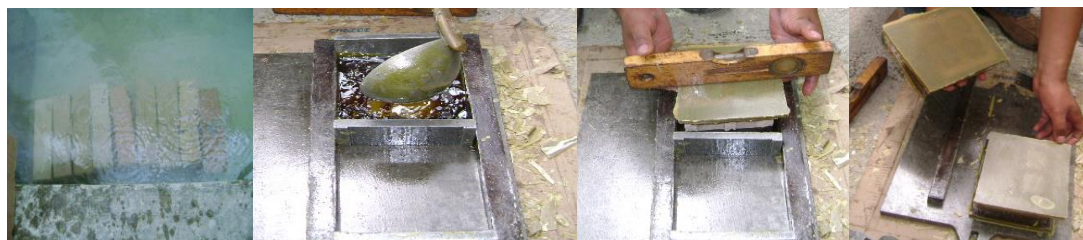
Fotos No. 71, 72, 73, 74 Pasos a seguir para el ensayo a compresión de unidades de mampostería saturadas
