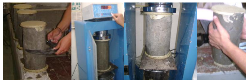
Fotos No. 60, 61, 62, 63 Medición de área de cilindros y rompimiento
