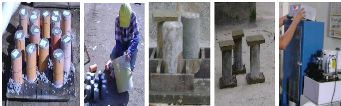
Fotos No. 47, 48, 49, 50, 51 Elaboración de ensayos para mortero de relleno (Grouting)
