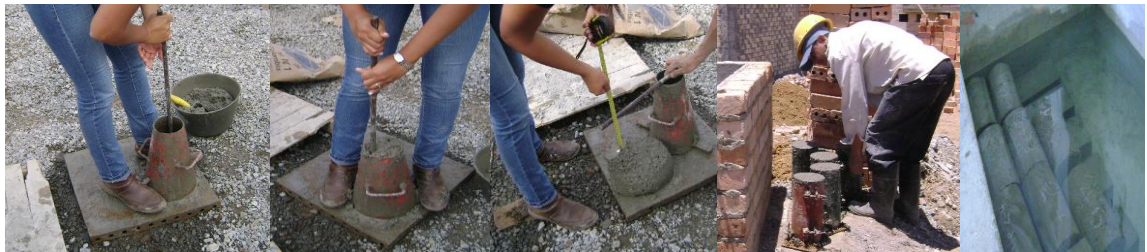
Fotos No. 50, 51, 52, 53, 54 Prueba de slump y ubicación de los cilindros cerca al tanque de almacenamiento
