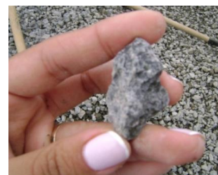
Foto No. 36. Agregado Grueso TMN \frac{3}{4} " Conexpe
