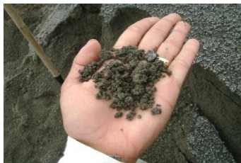
Foto No. 33 Agregado Fino Conexpe
