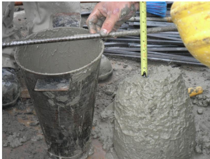
Fotografía No. 16 Toma de asentamiento - Slump
