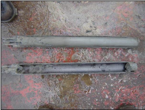
Limolita consistencia blanda a media ( N \approx 25 )
