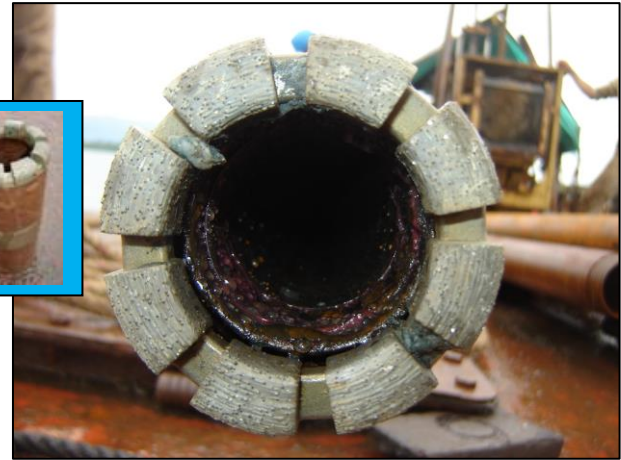
Fotografía 6 Broca de Barrena (tubería NQ)
