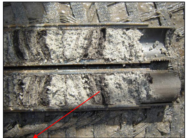
Arena blanca suelta, luego arena con lentes de turba ( N \approx 15 )
