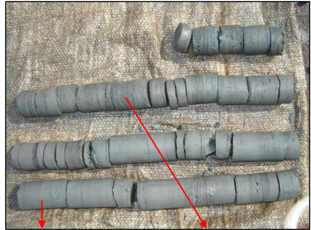
Limolita con lentes arenosos, luego arenisca con lentes de limolita (RQD=17.1%)
