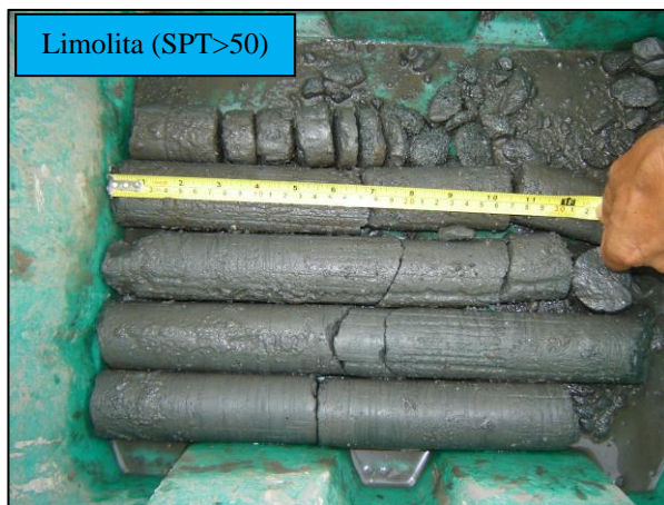
Fotografía 23 Núcleos de limolita
