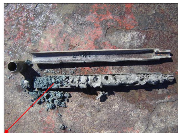
Limos arcillosos, luego limos compactos, luego arena de grano grueso color verdoso (SPT = 3-7-11, N = 18)
