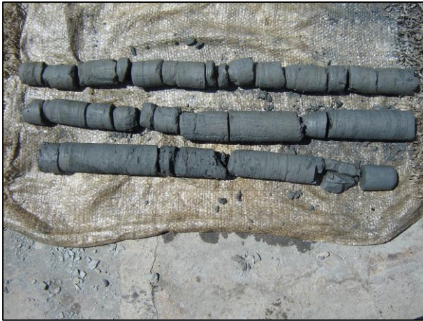
Limolita con lentes arenosos (RQD=19.6%)
