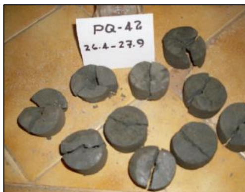
Fotografía 33 Especímenes fallados mediante pruebas axiales
