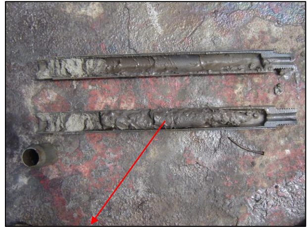
Arcilla con turba consistencia blanda ( N \approx 5 )
