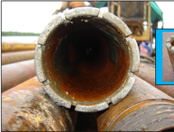
Fotografía 5 Broca de revestimiento (tubería NW)
