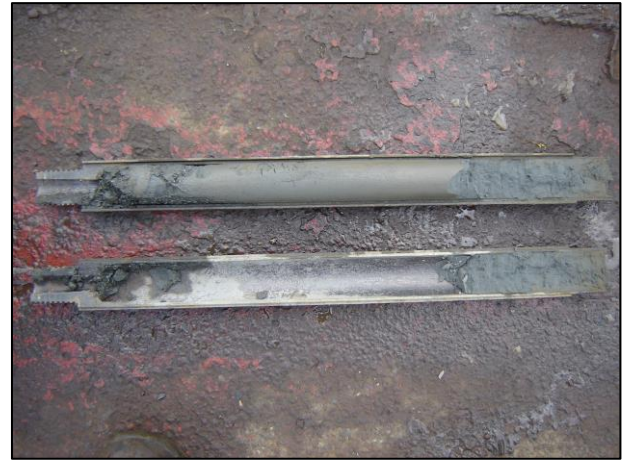
Limolita consistencia alta ( N > 50 )
