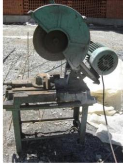
**Foto 127. Maquina utilizada para cortar barras de acero.**
