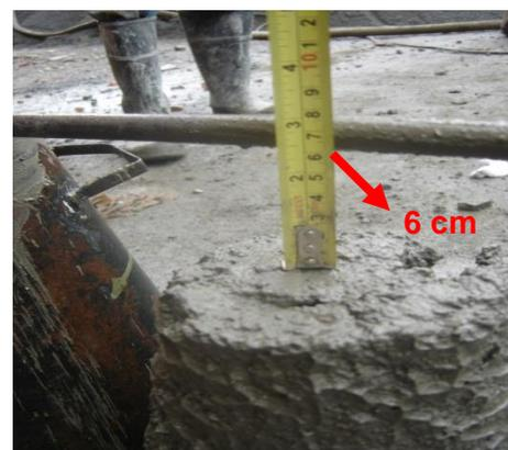
Foto 157. Ensayo de Asentamiento
