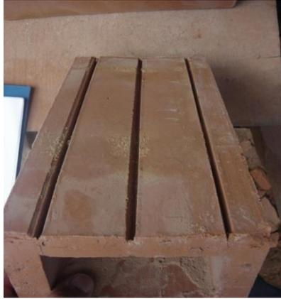
Foto 48. Unidad de mampostería Viga-bloque salida de fábrica.
