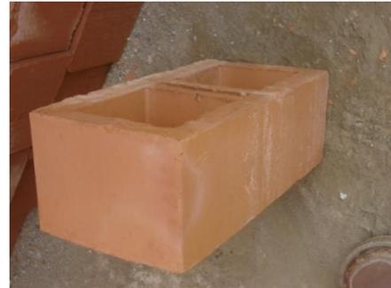
Foto 46. Ladrillo de perforación vertical.
