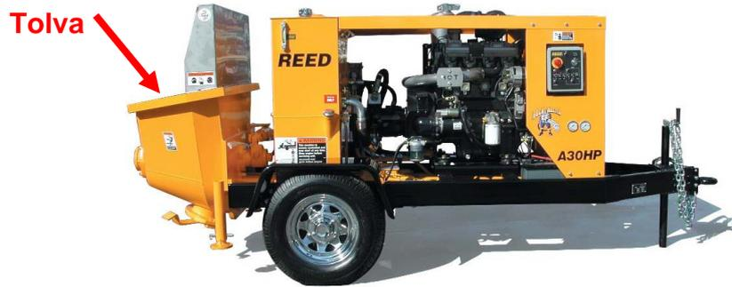
Foto 125. Bomba para concreto marca REED.
