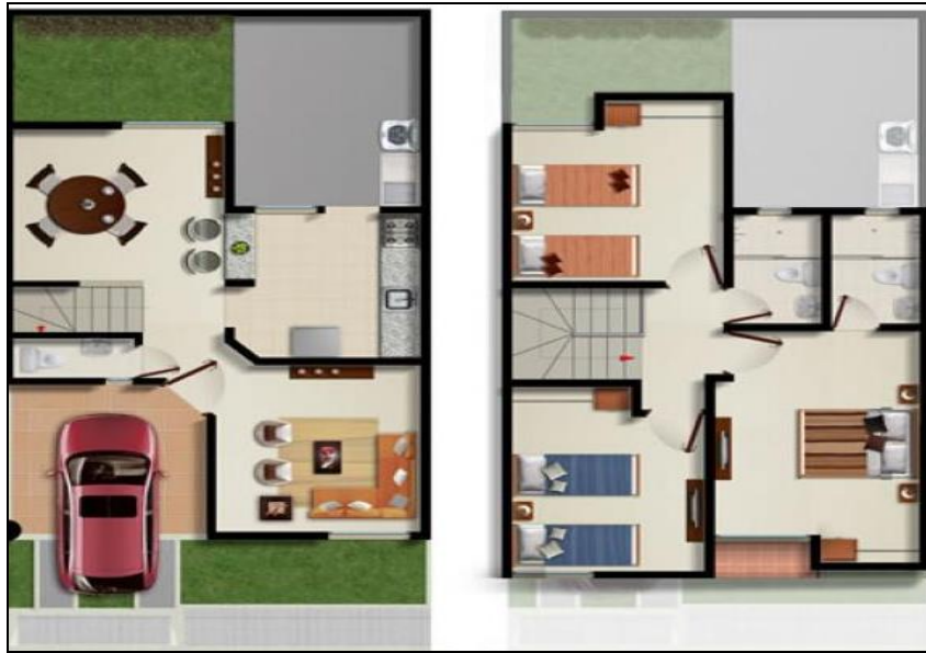
Ilustración 2.Plano En Planta De Las Casas Del Conjunto Cerrado Calatrava.
