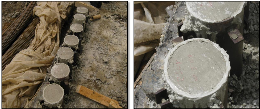
Muestras de concreto para la prueba de Resistencia
