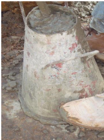
Figura 12. Ensayo de asentamiento en obra
