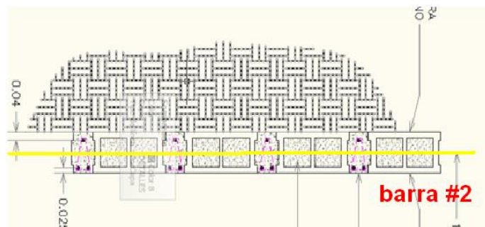
Figura 37. Refuerzo horizontal en muros de sótano
