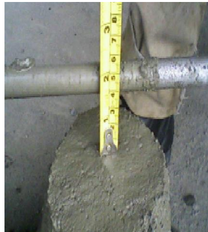
Figura 12. Ensayo de asentamiento en obra
