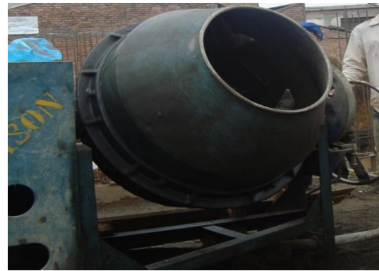
Figura 11. Mezcladora de 9 \text{ pies}^3
