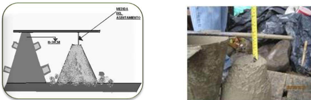
Figura 63. Medida del asentamiento de una mezcla de concreto con el Cono o Slump
