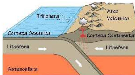
Figura 4. Esquema de subducción. Figura tomada del estudio Geología en las zonas de Subducción, Valera (2003).
