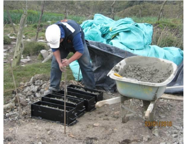
TOMA DE CILINDROS Y VIGAS EN OBRA
