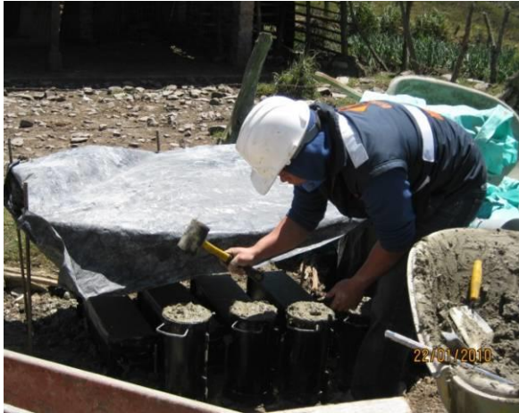
TOMA DE CILINDROS Y VIGAS EN OBRA
