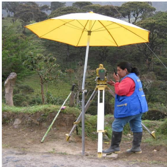
CHEQUEO COMISIÓN TOPOGRAFÍA INTERVENTORÍA TRAZADO POLIGONAL BASE
