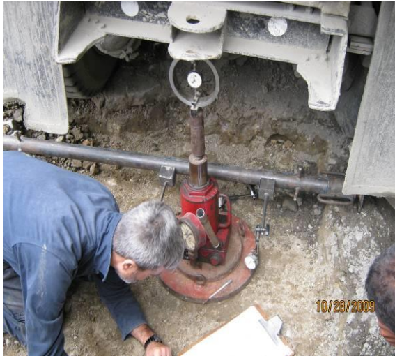
SEGUIMIENTO ENSAYO DE PLACAS Y TOMA DE DENSIDADES PR 45+0622 AL PR 56+0000
