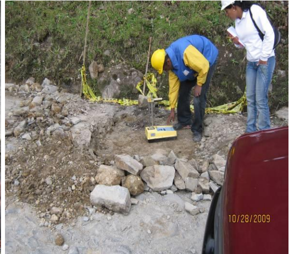
SEGUIMIENTO ENSAYO DE PLACAS Y TOMA DE DENSIDADES PR 45+0622 AL PR 56+0000
