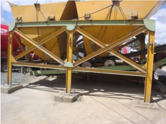
*Foto 4. Tolvas para el peso de los agregados*
