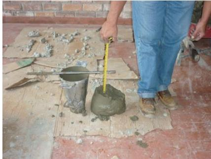
*Foto 31. Ensayo de Asentamiento*
