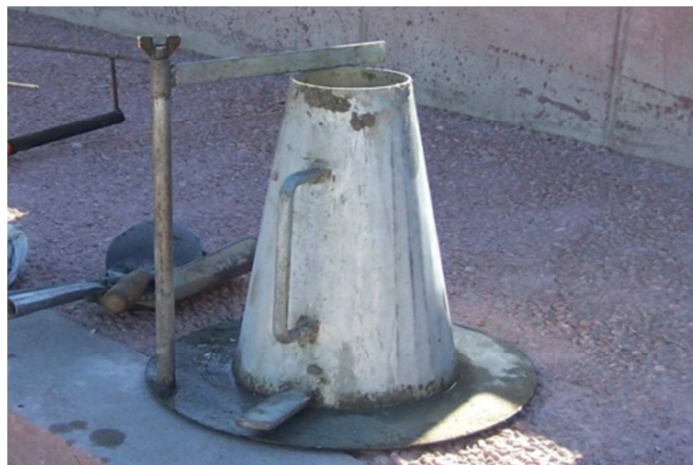
Figura 9. Cono de Abrams, para ensayo slump.
