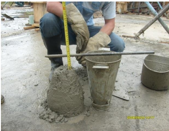
FIGURA 42 Ensayo de asentamiento
