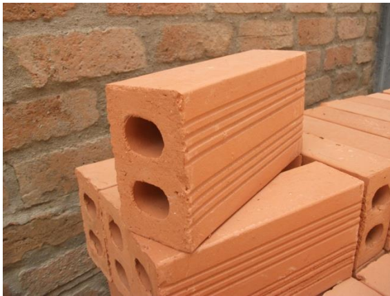
Foto No. 30 Bloque usado en la construcción del muro de cerramiento
