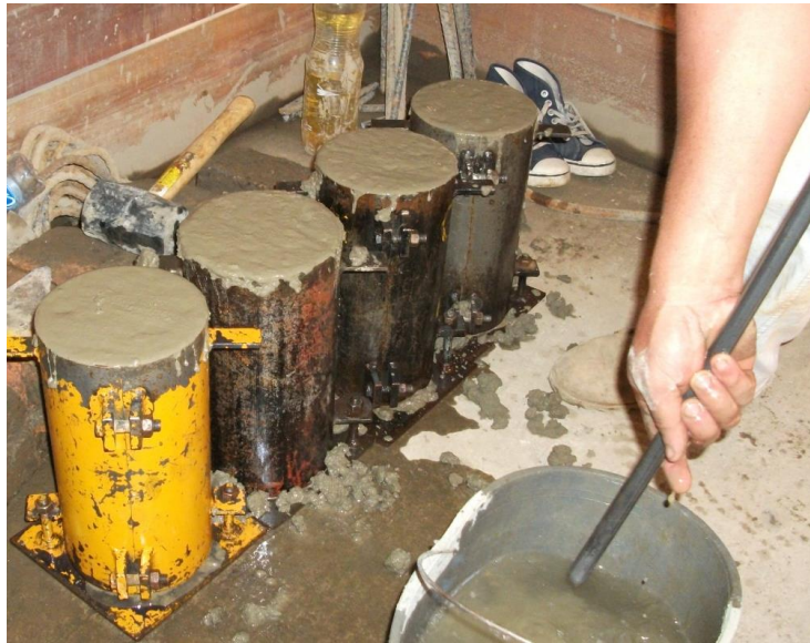
Foto No. 56 Elaboración de cilindros para el ensayo a compresión
