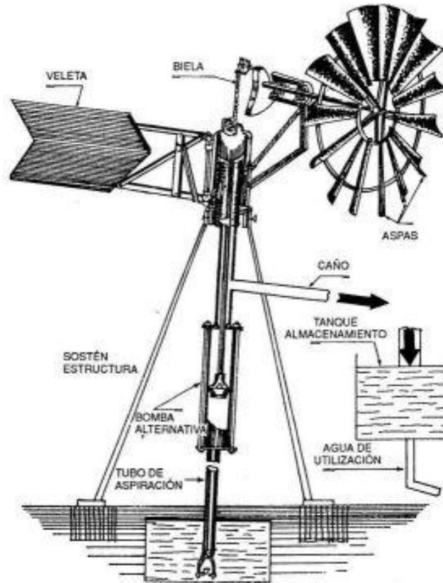
El bombeo del agua es accionado de forma mecánica por un pistón eólico, en el cual este pistón al descender aspira el agua embalsada por medio de una tubería sumergida en el tanque de almacenamiento que a su vez, al momento de su ascenso expulsa el agua aspirada hacia el sitio de depósito para sus diferentes usos.
