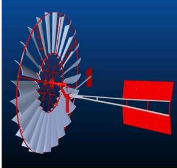
El rotor es de tipo eólico, en donde hace circular el viento en medio de las aspas y que a su vez hace girar este mecanismo y extrae la energía cinética del viento para convertirla en energía mecánica, que a su vez hace que esta energía se transfiera inmediatamente a la bomba de pistón ocasionando un movimiento rotacional del rotor en un movimiento oscilatorio ascendente y descendente por medio de la transición.
