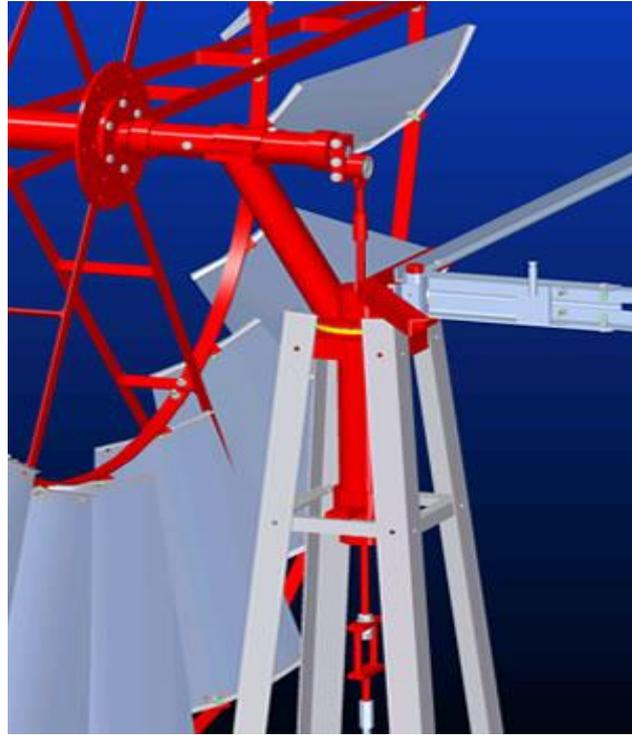
La transmisión es un conjunto de elementos metálicos que comprende la conexión del rotor con la biela hacia la varilla de actuación a la bomba de pistón, en donde se genera el movimiento del eje a la bomba mediante un mecanismo oscilante ascendente y descendente.
