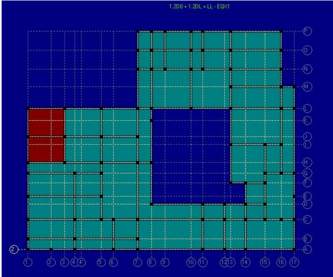
**NOTA:** el tipo de losa 1 esta denominado con color azul cielo, y el tipo de losa 2 está denotado con color vino tinto, ya que en esta sección se presenta una terraza con cubierta, del cual no tendrá sobre ella alguna carga significativa, por el cual tendrá las mismas condiciones de la losa tipo 2 de cubierta.
