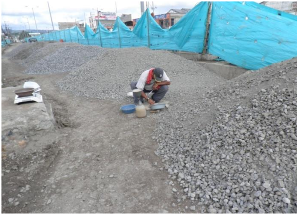
Fotografía 6: Evaluación cualitativa y cuantitativa del estado del material de subbase granular – Carrera 17 costado Suroccidental.
