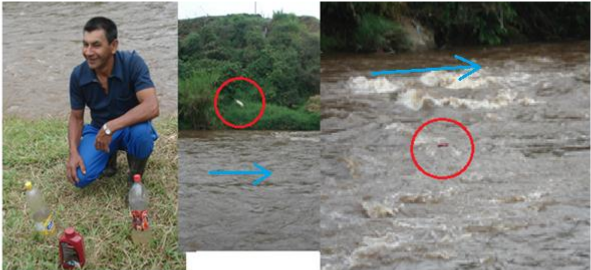
Fig. 6.15 Registro fotográfico para determinar el Caudal Superficial del río Cauca. Ref: Elaboración Propia.
