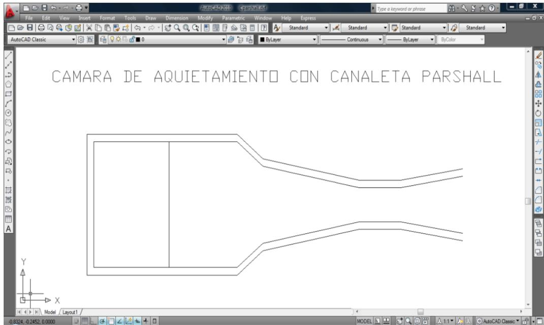
**Figura 22.** Plano en planta para el mezclador rápido con canaleta Parshall
