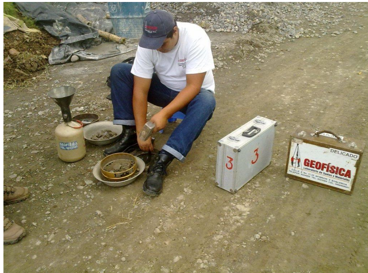
Figura 50. Densidad en sitio de sub-base mediante el ensayo de cono y arena.
