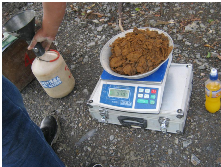
Figura 45. Densidad en sitio para Subrasante, Método del cono y Arena.
