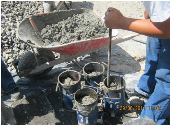
Figura 22. Fabricación de cilindros de prueba.
