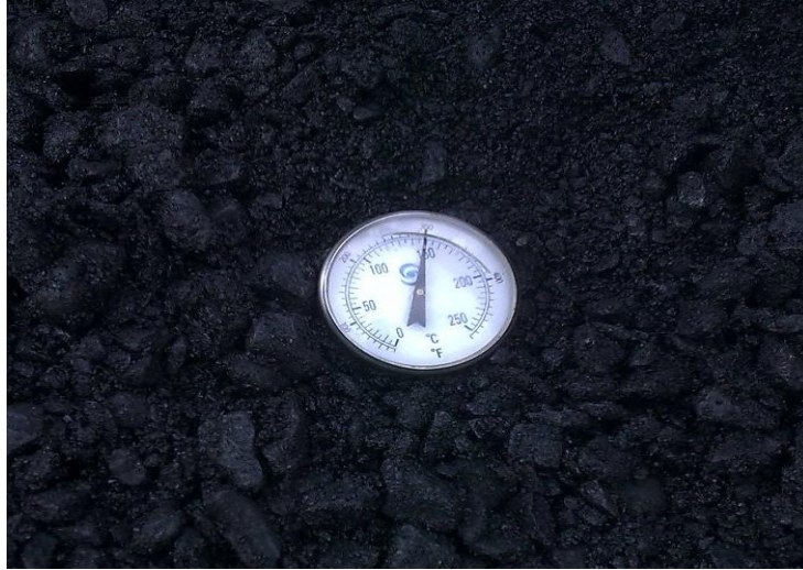
Figura 65. Medida de la temperatura de la mezcla.
