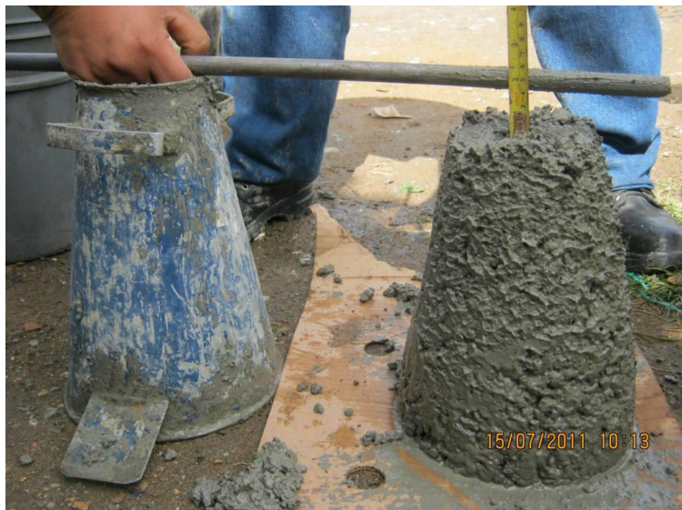
Figura 21. Ensayo en el cono de Abrams.
