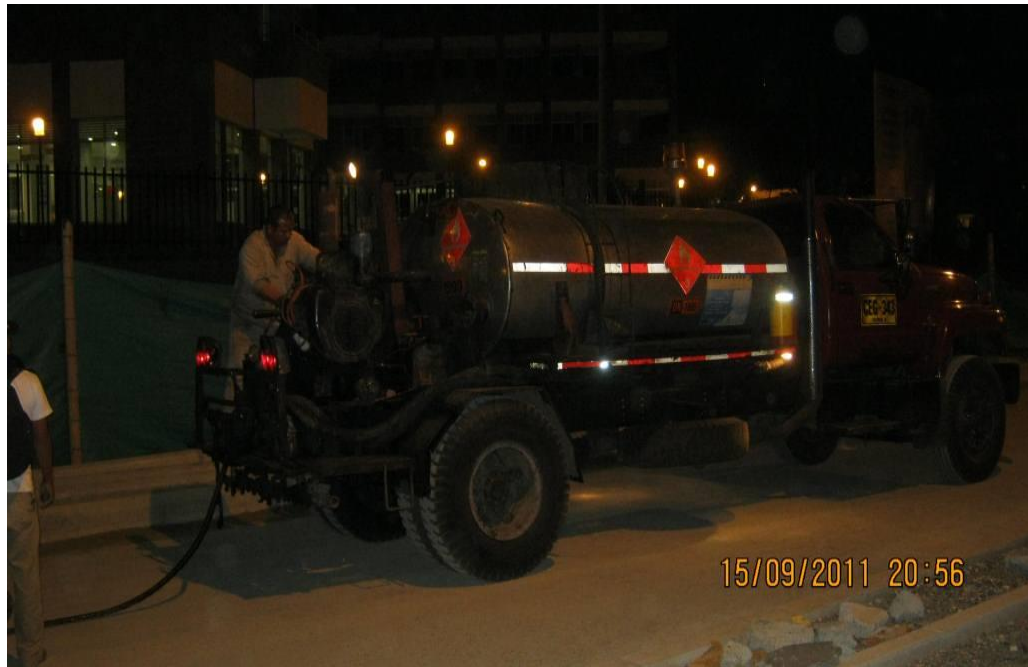
Figura 57. Carro tanque irrigador.
