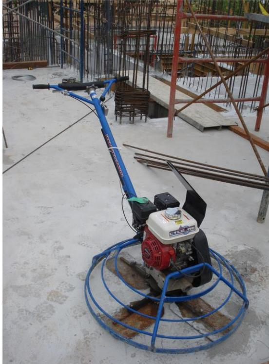
**Figura 27. Equipo de acabado para losas (Helicóptero)**
