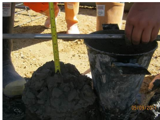
Fotografía 28. Toma asentamiento del concreto.
