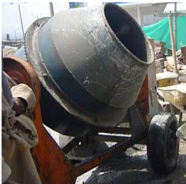
Fotografía 17. Mezcladora tipo trompo.
