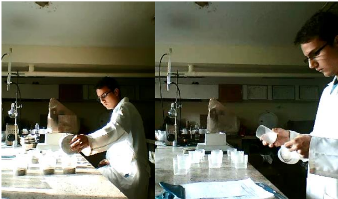
Ilustración 7. Dosificación de la arena y peso del porcentaje polvo fino deseado
