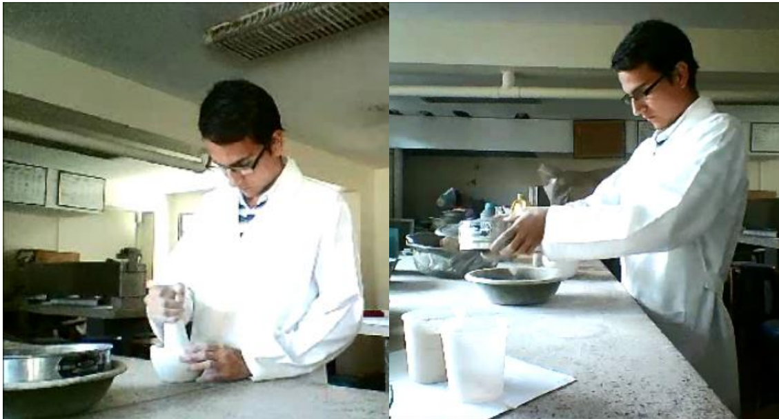
Ilustración 5. Preparación de la muestra por el mortero y el tamiz No. 200
