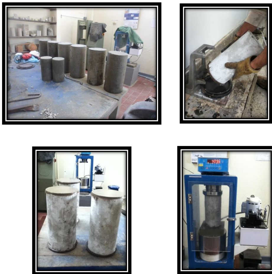
Ilustración 17: Etapas del ensayo de resistencia a la compresión del concreto simple.
