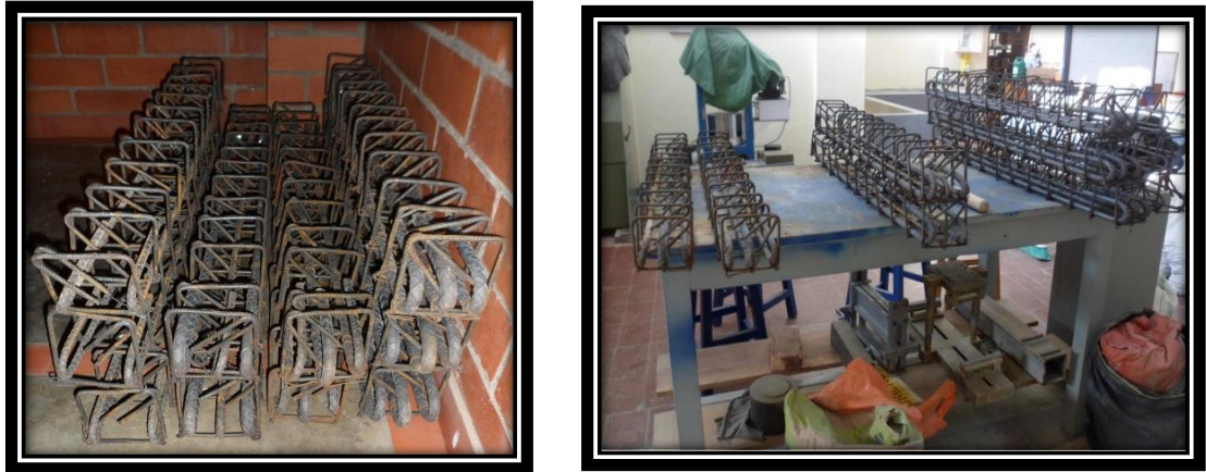
Ilustración 6. Castillos con diferentes cuantías de refuerzo.
