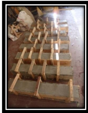
Ilustración 13. Proceso de desencofrado de vigas.
