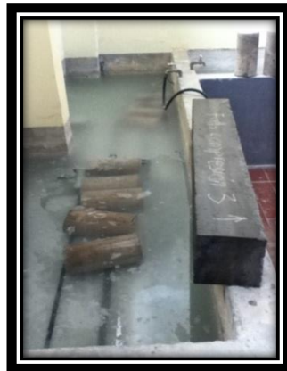
Ilustración 14. Proceso de curado durante y después de inmersión.
