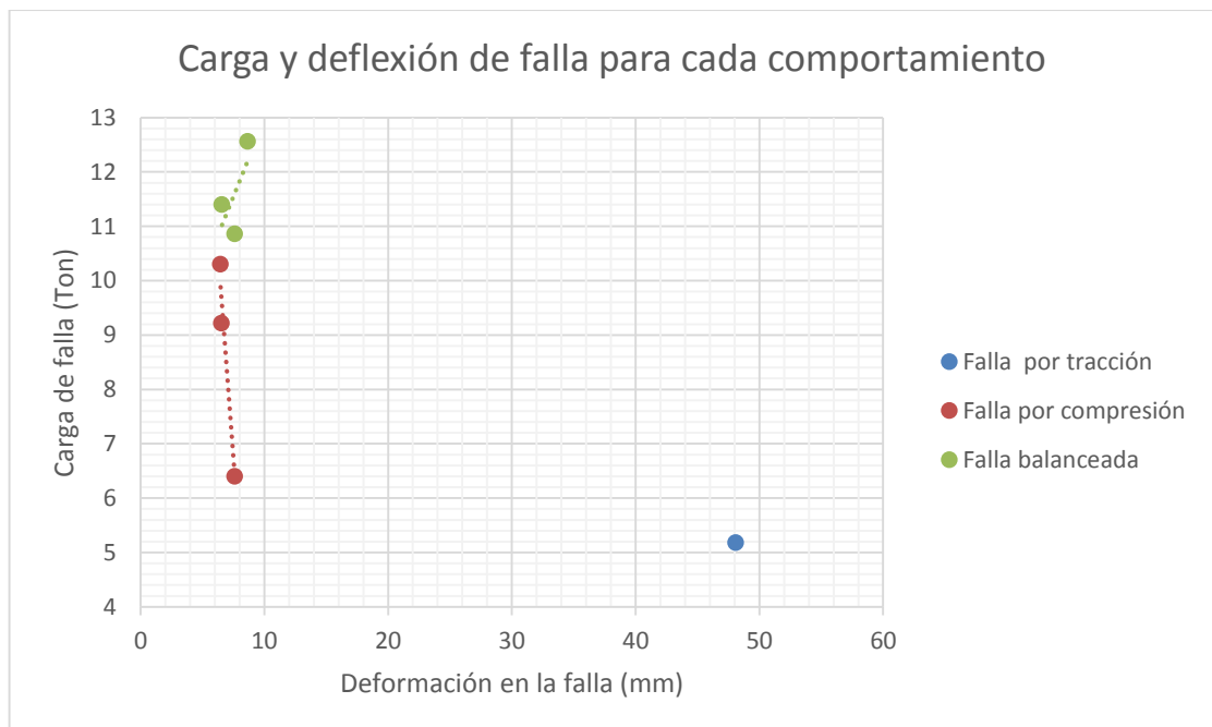
Ilustración 40. Cargas y deflexiones de falla para cada comportamiento.
