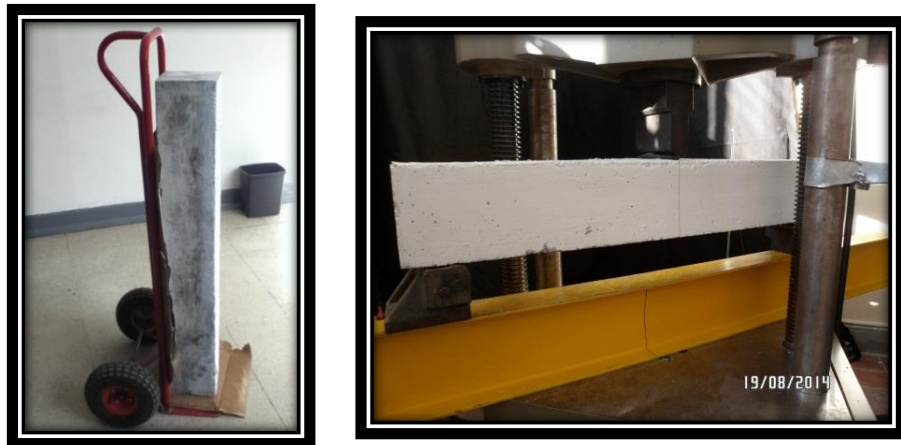
Ilustración 15. Transporte y montaje para prueba de carga.
