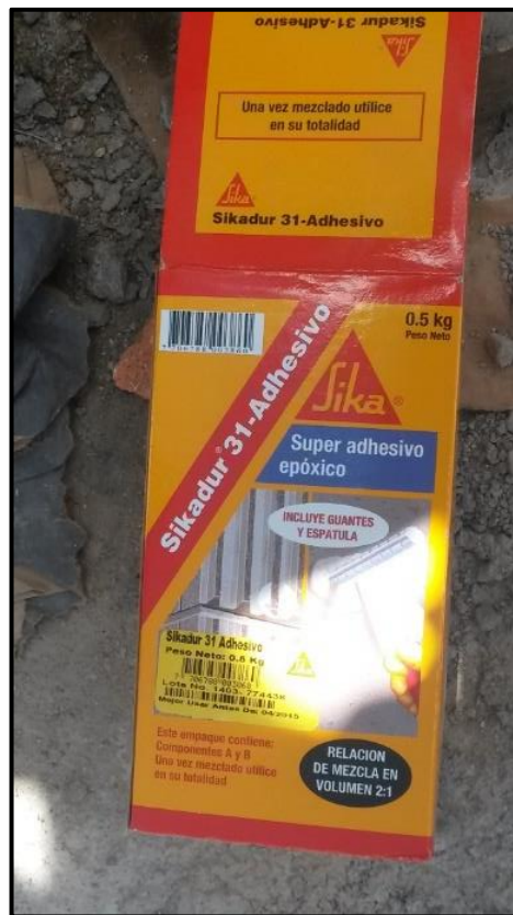
Figura 20 - Sikadur utilizado en anclajes. Fuente: Fotografía tomada por la pasante
