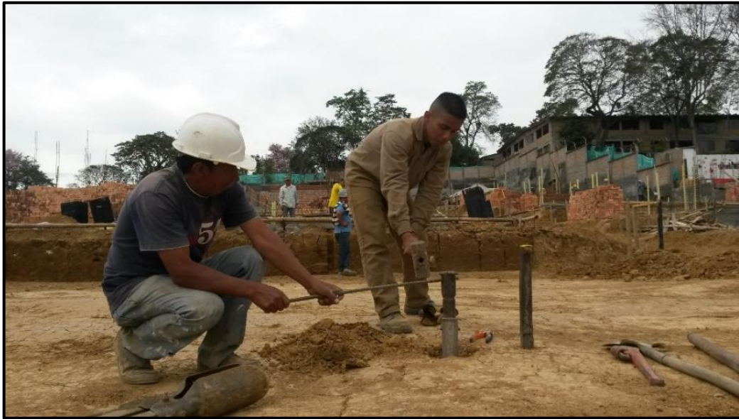
Figura 5 - Toma de muestras inalteradas con tubo Shelby. Fuente: Fotografía tomada por la pasante
