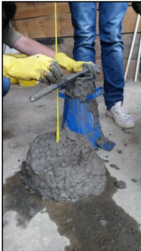
Figura 15 - Medida de asentamiento con el cono Slump. Fuente: Fotografía tomada por la pasante
