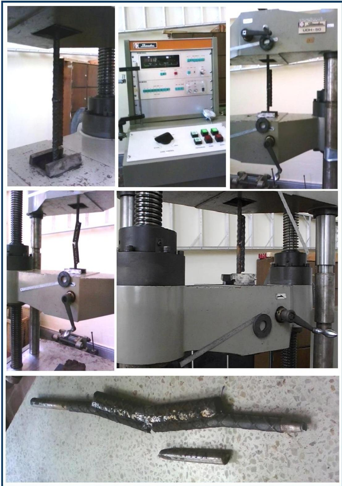
**Figura 95. Ensayo de las muestras**
