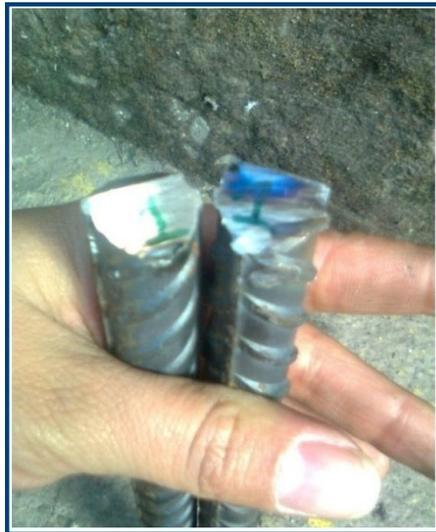
**Figura 60. Preparación barras a soldar**
