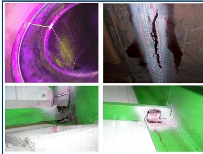
**Figura 50. Inspección por procedimientos de tinta penetrantes**
