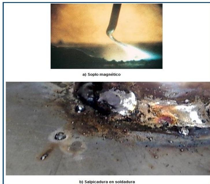
**Figura 38. Salpicadura debido al soplo magnético**
