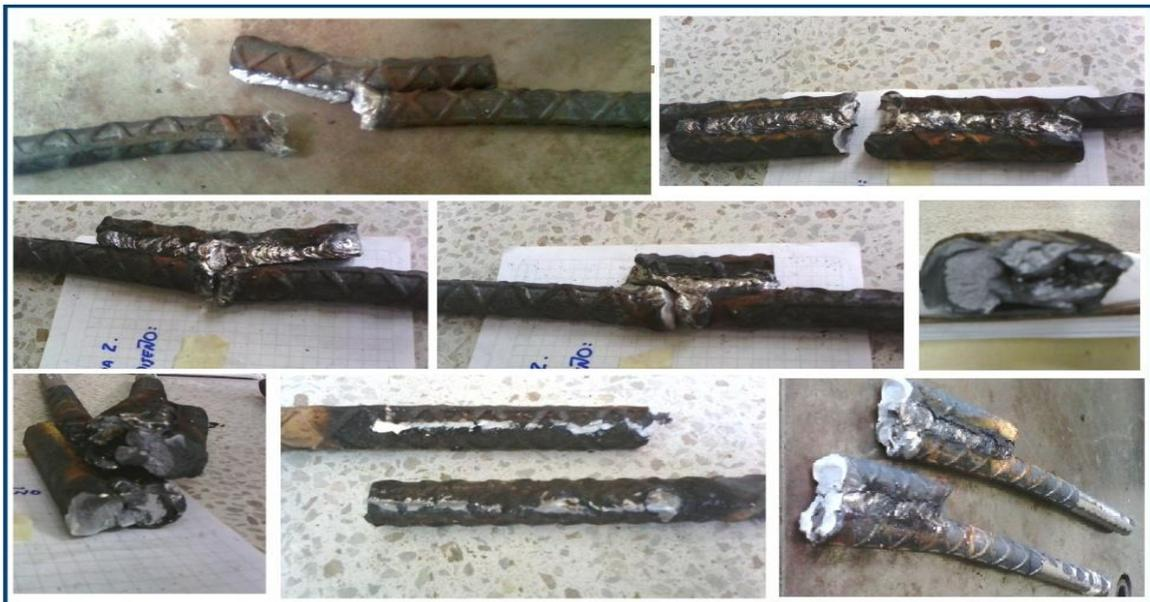
**Figura 88. Problemas de falta de material de aporte, penetración y porosidades**
