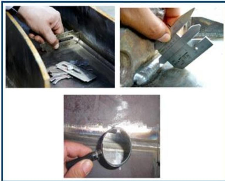
**Figura 49. Inspección visual de soldadura**
