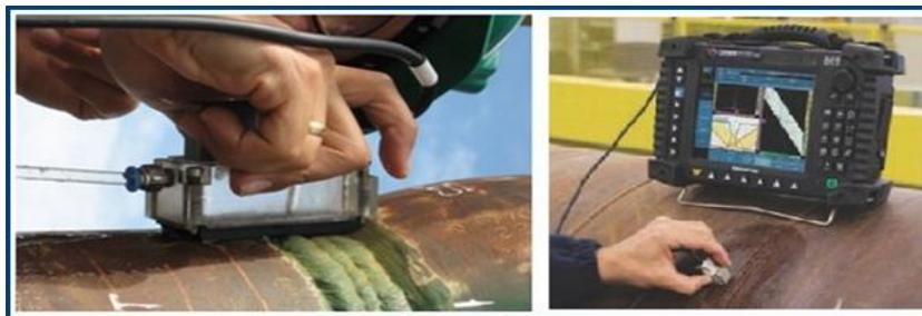
**Figura 52. Inspección por ultrasonido**
