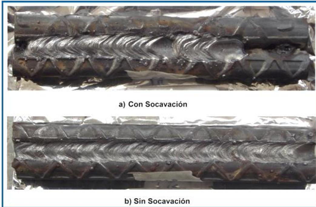
**Figura 65. Socavación**
