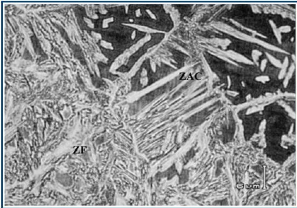
**Figura 10. Vista microscópica de micro fisuras en el acero**
