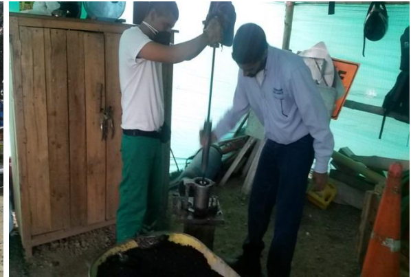
Imagen No.18 muestras de asfalto para ensayo de briketa
