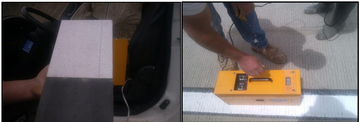
Imágenes No.73. Muestra ensayo de densidad y reflectómetro respectivamente
