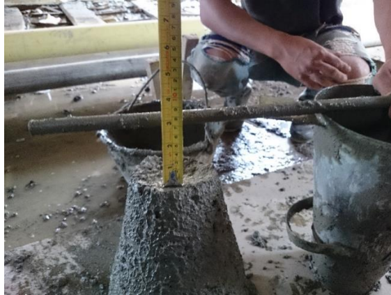
Figura No. 39 Ensayo de asentamiento SLUMP
