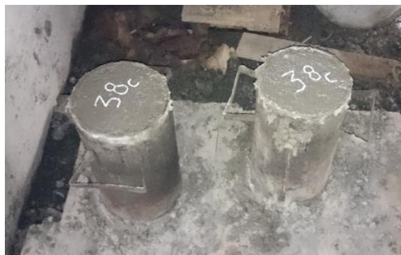
Figura No. 40 Cilindros tomados para ensayos de resistencia a la compresión
