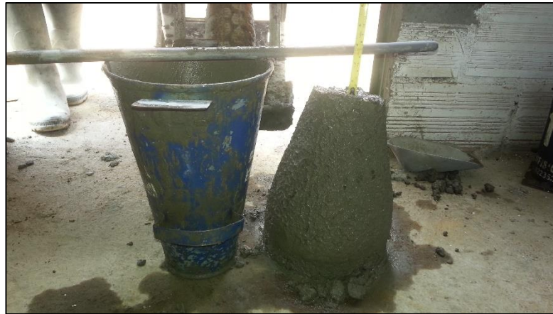
Figura No. 41 Ensayo in situ asentamiento
