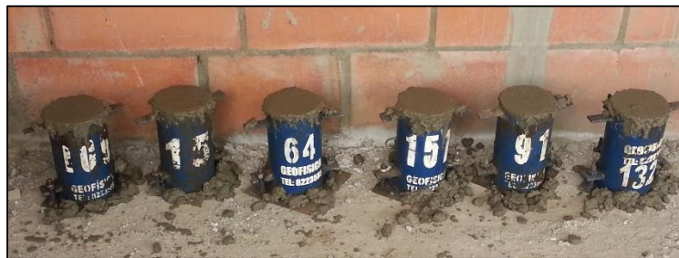
Figura No.42 Cilindros de concreto
