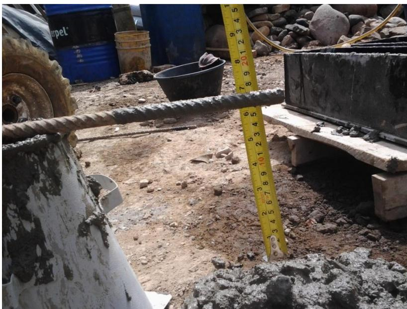
*Fig. 41. Se realizan ensayos de concreto*
