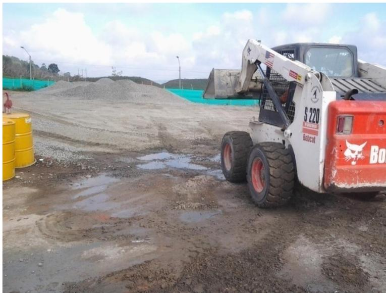
*Fig. 45. Se utiliza el mini cargador para alimentar la planta productora*
