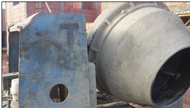
Figura No.26 Mezcladora con una capacidad de 6 pies 3 .
