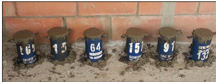
Figura No.33 Cilindros de concreto
