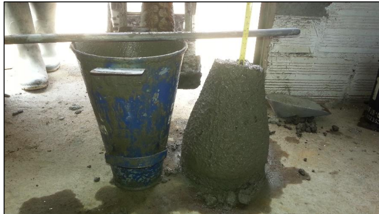
Figura No. 32 Ensayo in situ asentamiento
