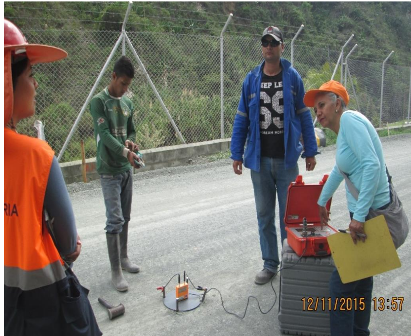
FIGURA 23. Toma de densidades a base granular (BG-40). Fuente propia
