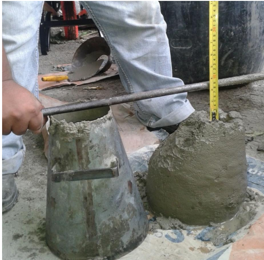
FIGURA 6. Prueba de asentamiento, cono slump. Fuente propia
