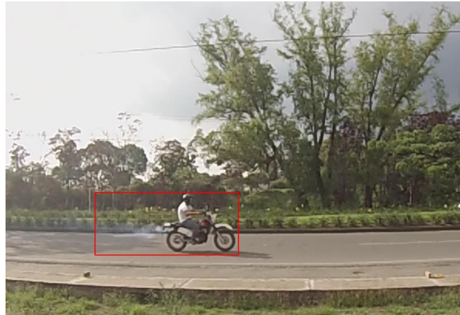
Figura 26. Detección de vehículos en presencia de humo vehicular. Fuente: Imagen propia.
