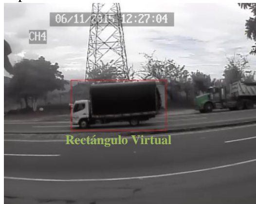
Figura 16. Detección de objetos en movimiento y rectángulo virtual. Fuente: Imagen propia.
