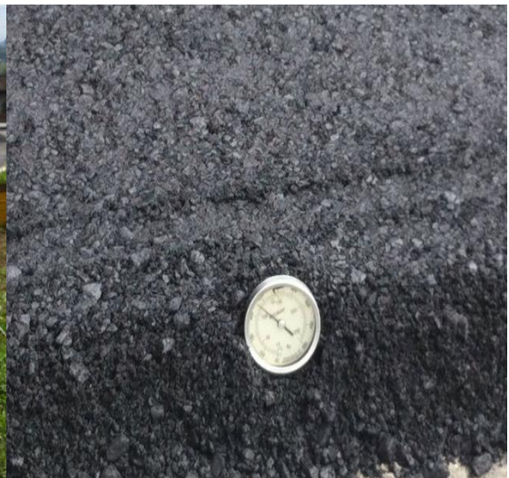
Figura 103. Temperatura de la mezcla asfáltica.
