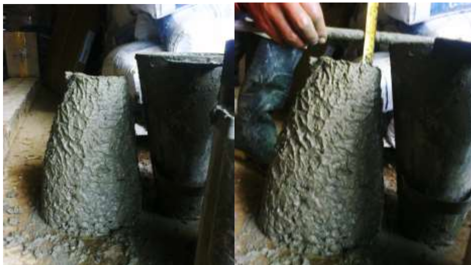
FIGURA No. 53 Ensayo de asentamiento del cono o slump.
