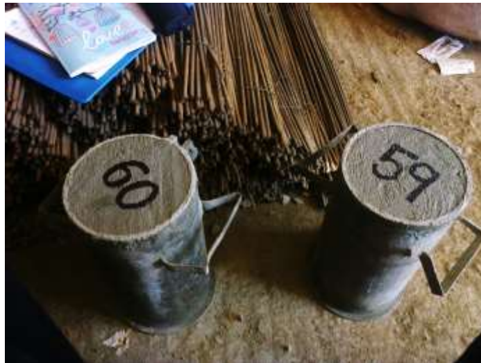
FIGURA No. 55 Cilindros de concreto
