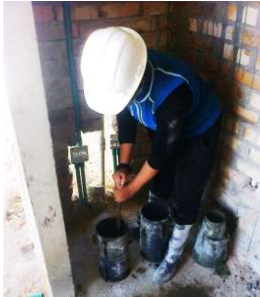
FIGURA No. 54 Elaboración cilindros de concreto
