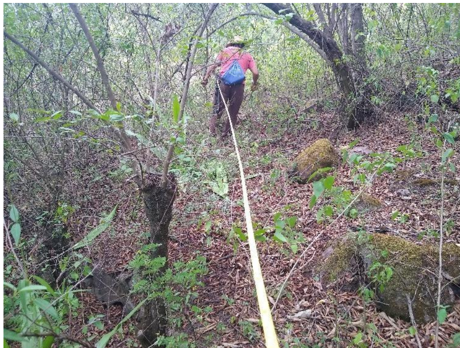
Figura 3. Marcación de pozos de sondeo. Municipio de Iles. El Porvenir. Octubre de 2020. Fuente: Propia.
