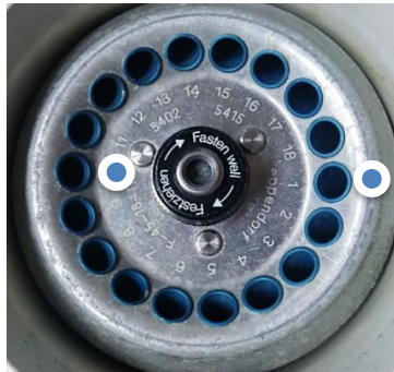
Fig. 2. Balanceo de la centrifuga de 10000 rpm
