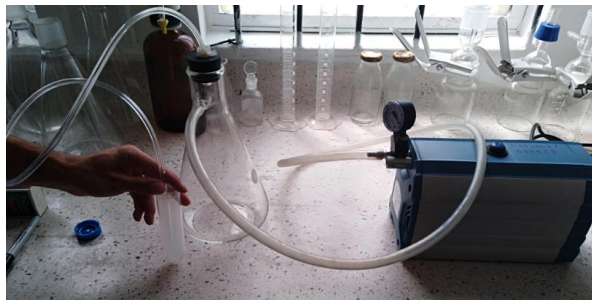
Fig. 1. Bomba de vacío, mangueras, Erlenmeyer y pipetas Pasteur.
