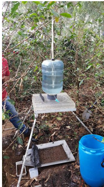
Figura 4. Minisimulador de lluvia instalado en campo.
