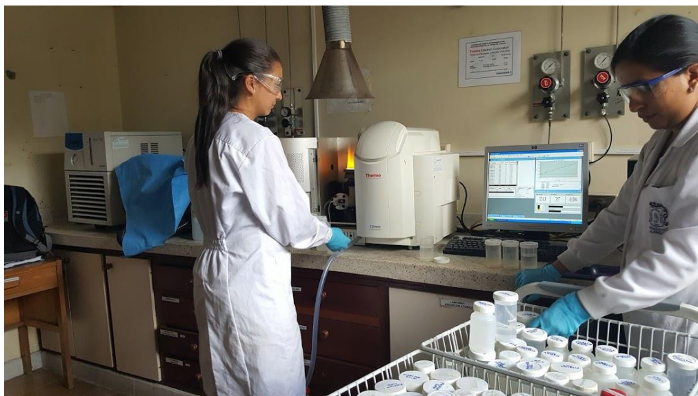
Figura 5. Mediciones de cobre por Espectrofotometría de absorción atómica.
