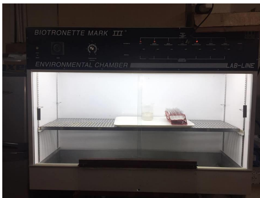
Figura 6. Cámara ambiental empleada en la prueba de toxicidad.
