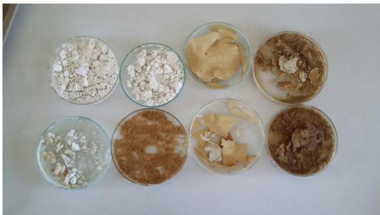
Figura 9. Muestras de almidón, fracciones retenidas por tamices y germen secadas en horno Dies
