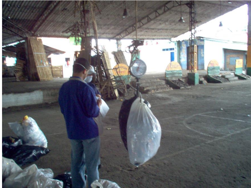
Figura 5. Proceso de pesaje de los Residuos Sólidos
