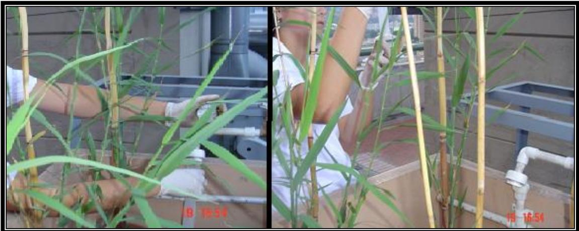
Imagen Nro. 10 Aforo volumétrico del caudal en el humedal A
