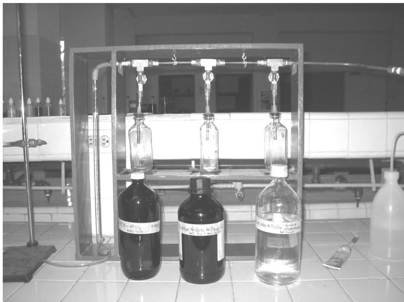
**Fotografía 2. Analizador de gases tipo Orsat**
