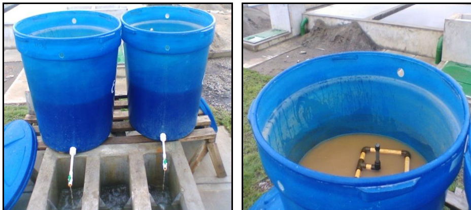
FIGURA 8. MONTAJE PARA DOSIFICACIÓN
