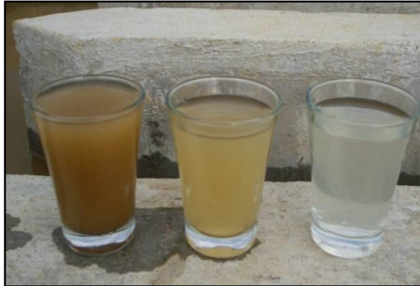
FIGURA 22. REMOCIÓN DE TURBIEDAD EN LOS FILTROS GRUESOS DE LA PLANTA FiME, ADICIONANDO SULFATO DE ALUMINIO
