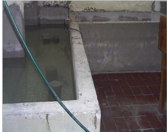
FOTO 2. Tanque de curado de cilindros de concreto
